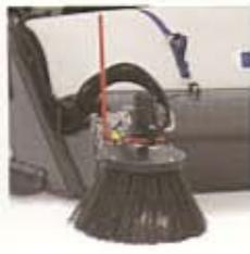
Seitenbürste, mechanisches Anheben/Absenken.
