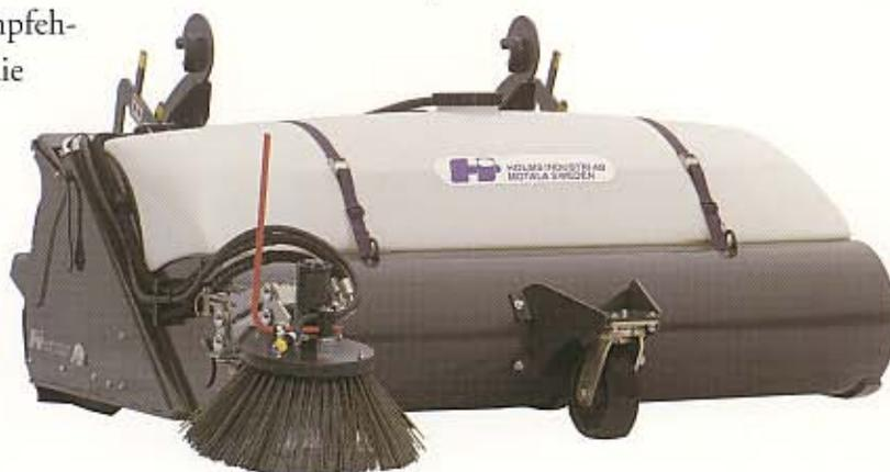
Das Spannband lösen und den Tank anheben – so einfach werden Kehrwalze und Schmutzbehälter zum Reinigen zugänglich.
