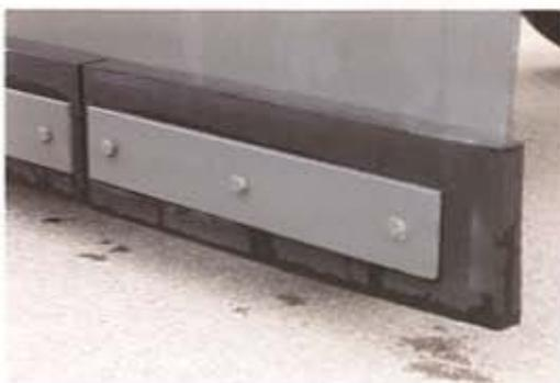
**Gummischar** Eine kräftige Gummischar zum Räumen von Schneematsch. Die Schar hat eine Stärke von ca. 55 mm und ist im Hinblick auf die Verschleißfestigkeit der Stahlschar überlegen. Ermöglicht ein geräuscharmes, gründliches Räumen, ist jedoch bei stark verdichtetem oder vereistem Untergrund weniger geeignet.
