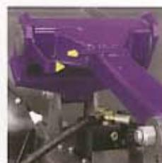
**Floatarm™** – zum einfachen Regulieren des Bodendrucks unter Last.
